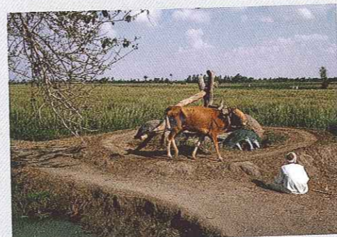
Proste urządzenia irygacyjne, takie jak pompa wprawiana w ruch przez byki, są wykorzystywane w Egipcie do dziś.
