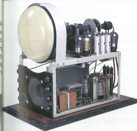
Pierwsze telewizory z lat 30. XX w. były wyposażone w niewielką lampę kineskopową. ■ fotografia, Wielka Brytania, XX w.
