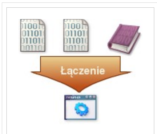
Rys. 2: Linker łączy wszystkie moduły binarne i biblioteki, tworząc gotowy do uruchomienia program
